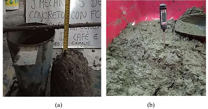
Fig.5 (a) ensayo de asentamiento y (b) control de temperatura
