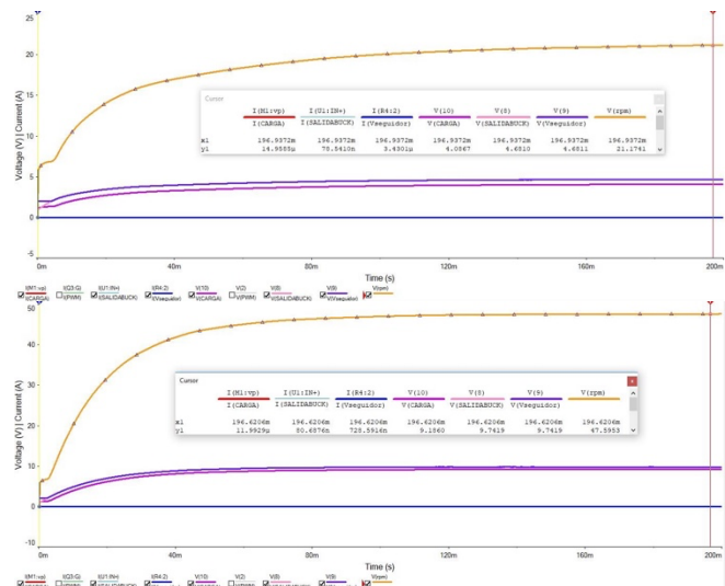
Fig. 8. Simulación con ciclos de trabajo del 25 % y del 75 % y sin resistencia en el motor
