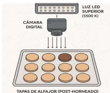
Figura 2. Esquema del sistema de iluminación frontal utilizado para la captura de tapas de alfajor
