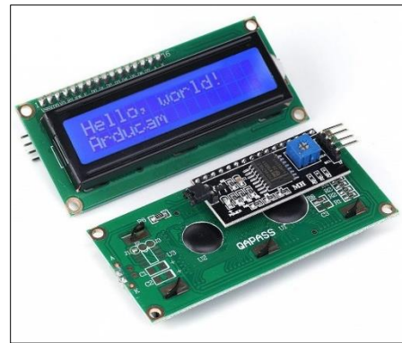
Fig. 4. Display 1602 con I2C
