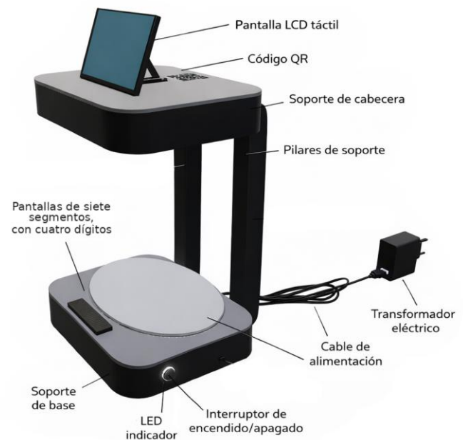
Fig. 1. Vista general y disposición física de los componentes del prototipo.
