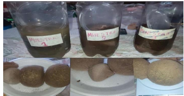
Fig. 3. Preparación de biofiltros con materiales orgánicos encapsulados en malla nylon
