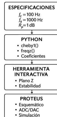
Figura 2: Diagrama de flujo detallado de la metodología PPA-DSP con las tres fases principales
