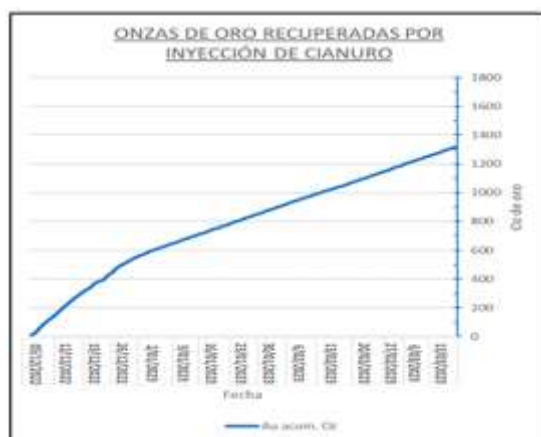
Fig. 12 Onzas recuperadas mediante la inyección de cianuro a presión.
