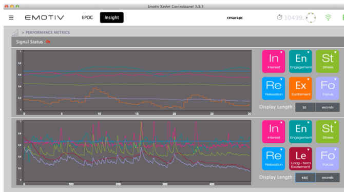
Fig. 3 Registro de neuroseñales correspondientes a los estados emotivos empleando la suit Emotiv Xavier Controlpanel
