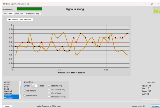
Fig. 7 Captura de los niveles de atención y meditación por medio Interfaz cerebro computador MindWave mobile 2 y la plataforma de Neuro Experimenter.
