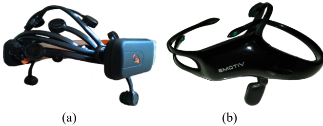
Fig. 2 Interfaces cerebro computador de la empresa Emotiv empleadas en este estudio. a) Emotiv EPOC+, b) Emotiv Insight
