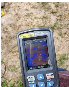
Fig. 5 Comparación de medición con termómetro infrarrojo Fluke.
