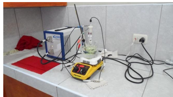
Fig. 2 Montaje experimental del circuito electroquímico con celda de tres electrodos utilizado para los ensayos de corrosión.
