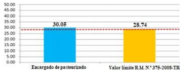
Fig. 4 Comparación del valor promedio obtenido por las mediciones realizadas (tres mediciones) del índice WBGT registradas mediante el termohigrómetro INLITE modelo ITEMP, con el límite permisible.
