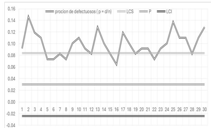
Fig. 2 Gráfico de control p del proceso antes de la estandarización.
