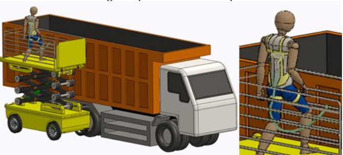
Fig. 6 Implementación de plataforma elevadora
