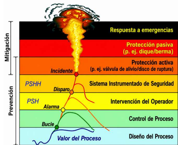
Fig. 3 Esquema de capas de protección operativa y respuesta del sistema ante sobrepresiones transitorias. Fuente: Adaptación de F. Pawolocki (2021)
