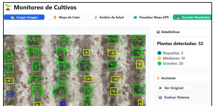
Fig. 9. Interfaz gráfica del sistema de monitoreo de cultivos mostrando la detección y clasificación automática de plantas.
