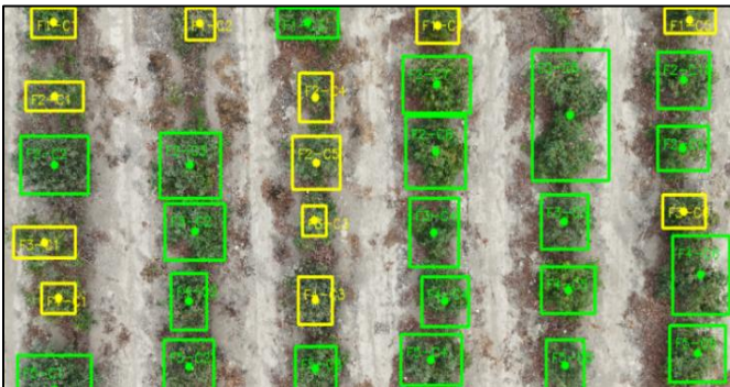
Fig. 7. Resultado del procesamiento de imágenes aéreas mediante el sistema desarrollado, mostrando la detección y clasificación de plantas de palta en categorías de tamaño (pequeñas, medianas y grandes).
