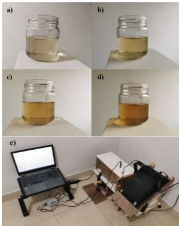
Fig. 1 Nanofluidos preparados bajo diferentes concentraciones. a) 2%, b) 4%, c) 6%, d) 8% CuO/agua y e) sistema de conducción y calentamiento de fluido caloportador en el proceso de toma de datos de temperatura.
