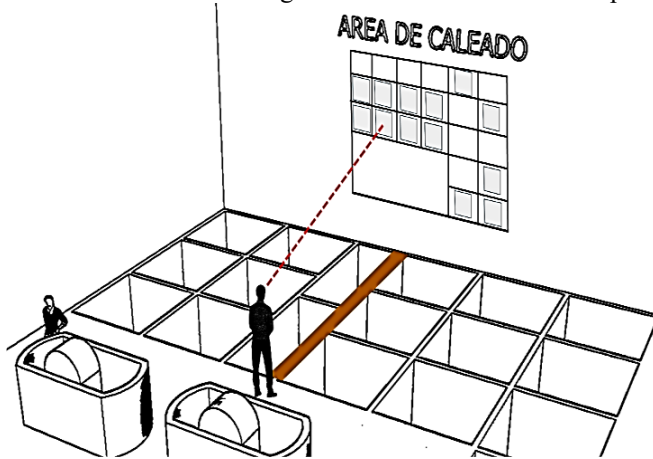
Fig. 4 Prototipo final del tablero Kanban en el proceso de caleado.
