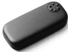
Fig. 7. Carcasa de resina acrílica como estructura interna y protección.
