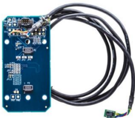
Fig. 3. Sensor ADPD144RI (PPG Integrado) en contacto con la piel.
