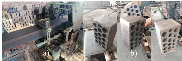
Fig.4 a) Proceso de Moldeado, b) Proceso de Secado.
