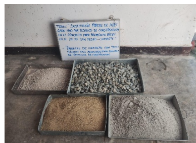
Fig. 2 Agregados para el diseño de mezcla del concreto patrón y para el diseño del 20%, 40% y 60%.
