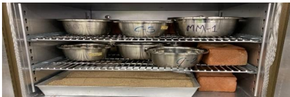
Fig. 8. Ensayo de humedad de agregados finos, gruesos y arcilla expandida. (Elaboración propia)
