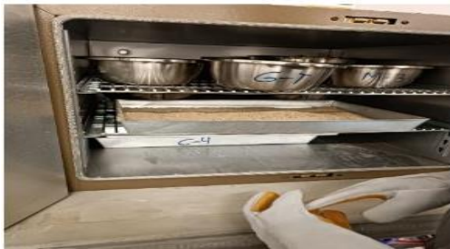
Fig.10. Ensayo de humedad en los agregados gruesos, finos y AE. (Elaboración propia)
