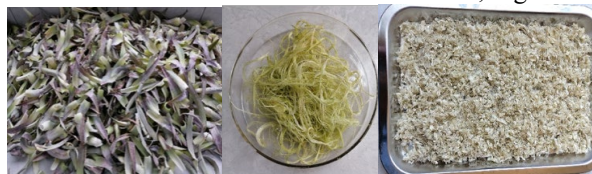
Fig. 2. Hojas de corona de piña, desfibrado y fibras cortadas.
