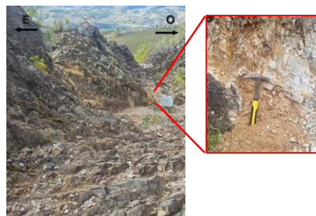
Figura N° 9: Se observó abundante arenisca. Con ayuda de la Tabla Munsell y la presencia de los colores blanquecinos se interpretó como Arena (Cuarzosa).
