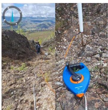
Figura N° 1: Sección a través de un Sondeo Eléctrico Vertical realizado para identificar la profundidad del banco de arenisca. A la izquierda, la línea de sección. A la derecha, uno de los dos electrodos usados para inyectar corriente. (N 9205005 E 798807 – N 9205035 E 798839).
