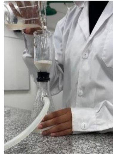
Fig. 5 Filtración al vacío
