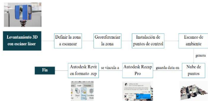
Fig. 11. Flujoograma levantamiento 3D con escáner láser
