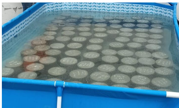
Fig. 1 Proceso de curado de testigos de concreto
