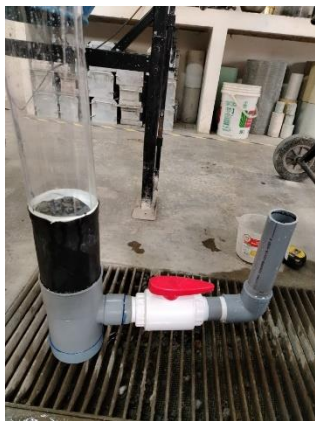
Fig. 4. Permeámetro casero elaborado de acuerdo con el ACI 522R-10
