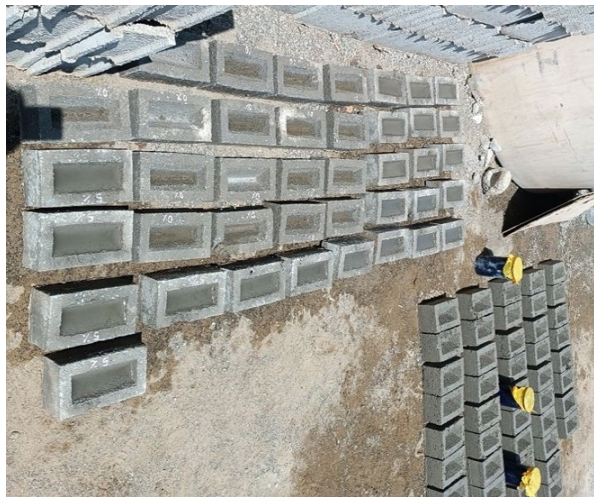
Fig. 6 Probetas de bloques de concreto elaboradas.
