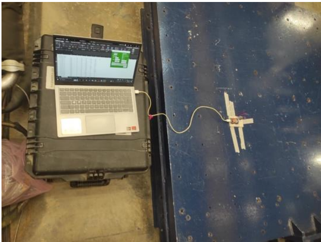
Fig. 3 Ubicación del MPU6050 en la mesa vibratoria MTS. Fuente: [16].
