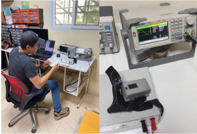
Fig. 6 Preparación del equipo en el generador de vibraciones para recolección y análisis de datos en MATLAB.
