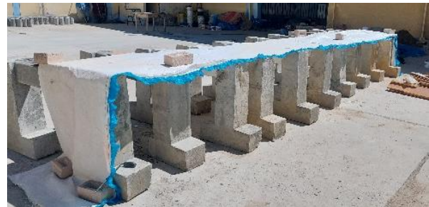
Fig. 1. Estructuras listas para ser ensayadas. Obtenida de “Resistencia a fuerza cortante de vigas con y sin fibra de acero al ser reforzadas con carbono después de haber alcanzado su falla última” [1]
