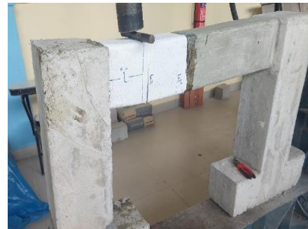
Fig. 2. Ensayos de pórticos. Obtenida de “Resistencia a fuerza cortante de vigas con y sin fibra de acero al ser reforzadas con carbono después de haber alcanzado su falla última” [1]
