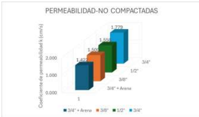
Fig.7 Resultados gráficos obtenidos de los ensayos de permeabilidad que nos muestra el coeficiente de permeabilidad k (cm/s) de menor a mayor de las 4 muestras de concreto permeable no compactado.
