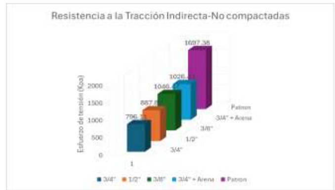
Fig. 5 Resultados gráficos que se obtuvieron del ensayo de resistencia a la tracción en especímenes No compactados y la muestra patrón.
