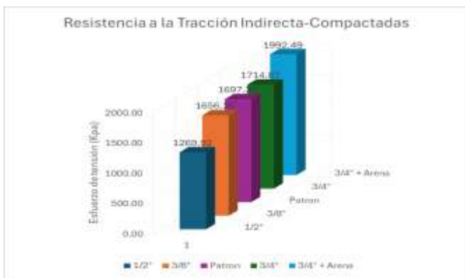
Fig. 4 Resultados gráficos obtenidos del ensayo de resistencia a la tracción en especímenes compactados y la muestra patrón.
