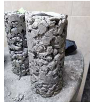
Fig.9 Imagen referencial de las muestras utilizadas con agregado de 3/4\" mas un porcentaje de arena.
