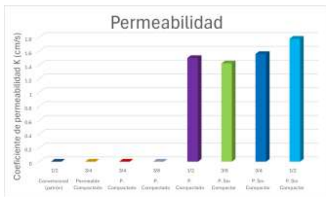
Fig.10 Grafico comparativo de los resultados de permeabilidad de todos los especímenes utilizados (Los especímenes compactados y la muestra patrón no presentan permeabilidad ya que no tiene la cantidad suficiente de poros para permitir el paso del agua).
