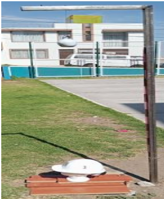
Fig. 2 Armado de estructura de soporte para pruebas de impacto
