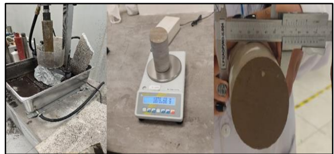
Fig. 3 Extracción, pesaje y medición de testigo N°1
