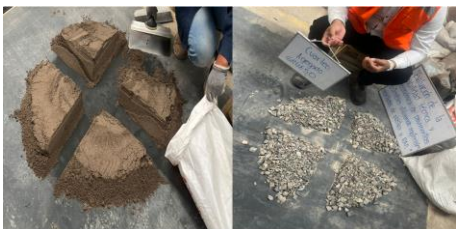
Figura 2 Cuarteo de material fino y material grueso
