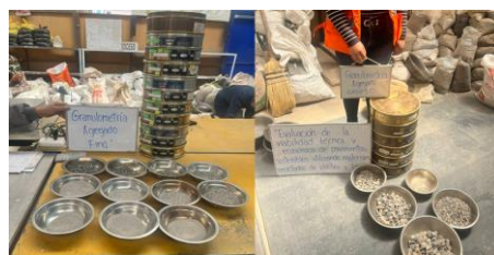
Figura 3 Granulometría de agregado fino y agregado grueso
