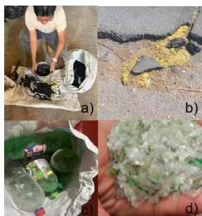
Figura 1 Identificación de RAP, en a) pavimento recuperado triturado, b) pavimento recuperado de carreteras, c) PET reciclado y d) PET picado
