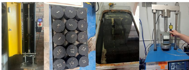
Fig. 7 Compactación de briquetas, análisis de resistencia de humedad y ensayo de Marshall
