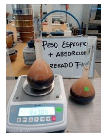
Figura 4 Peso específico y absorción de material fino
