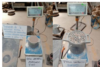
Figura 5 Peso unitario de agregado fino y agregado grueso
