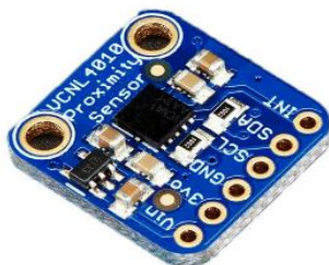
Fig. 6 Sensor de proximidad infrarrojo VCNL4010
