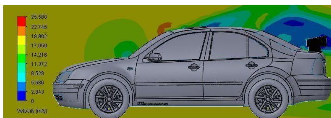
Figura 10. Simulación con alerón de la fuerza aerodinámica
