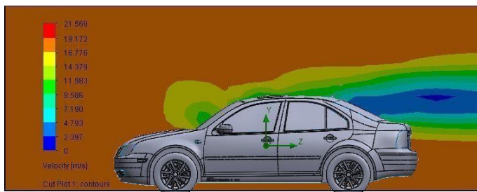
Figura 7. Simulación sin alerón de la fuerza aerodinámica
