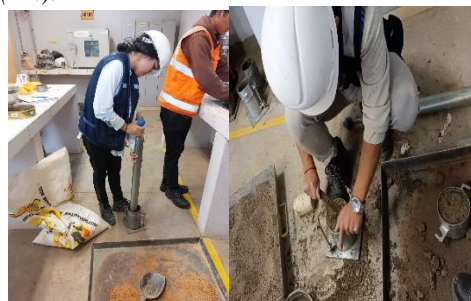
Fig. 04 Compactando y enrasando las muestras
