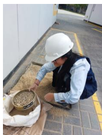
Fig. 02 Tamizado de suelo por la malla N°4
