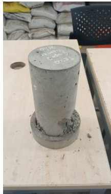
Fig. 10 Probeta sin curar luego de ser ensayada en el día 14.
