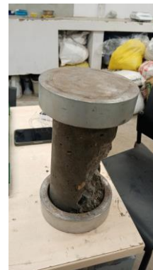
Fig. 7 Probeta curada luego de ser ensayada en el día 3.
