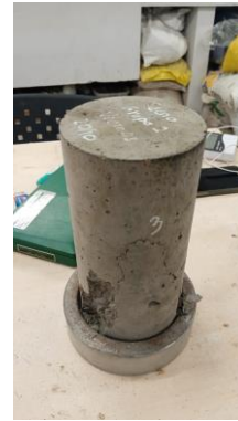
Fig. 6 Probeta sin curar luego de ser ensayada en el día 3.
