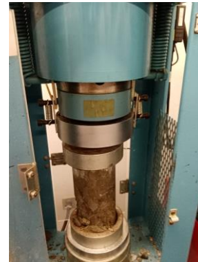
Fig. 13 Probeta curada luego de ser ensayada en el día 28.
