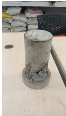
Fig. 8 Probeta sin curar luego de ser ensayada en el día 7.
