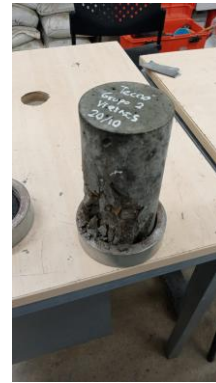
Fig. 11 Probeta curada luego de ser ensayada en el día 14.
