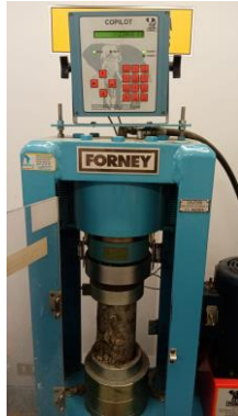
Fig. 9 Probeta curada luego de ser ensayada en el día 7.
