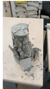
Fig. 12 Probeta sin curar luego de ser ensayada en el día 28.
