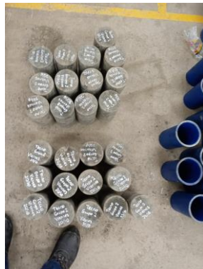
Fig. 3 Desmoldeo de probetas de concreto.
