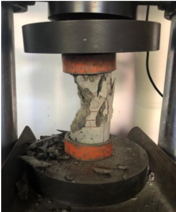
Fig. 4 Ensayo a compresión de probetas cilíndricas
