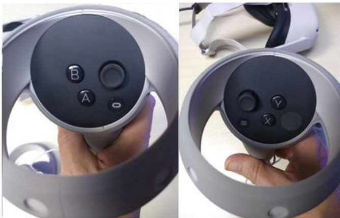
Fig. 2 Vista frontal de los comandos de los joysticks.
