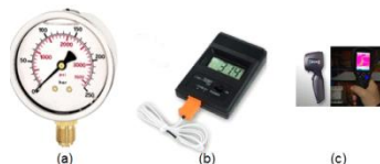
Fig. 1 Instrumentación: (a) Manómetro, (b) Termocupla e (c) Cámara termográfica
