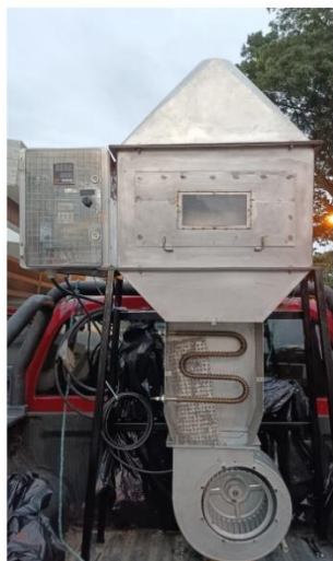
Fig. 10 Secador de lecho fluidizado - partes internas del equipo.
