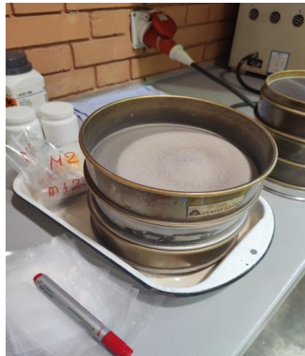
Fig. 3 Tamizado del relave seco
