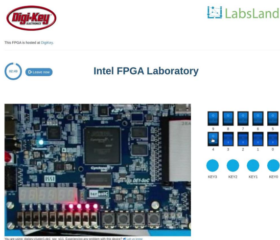
Fig. 2 Tarjeta FPGA remota en el entorno de trabajo Labsland [29].
