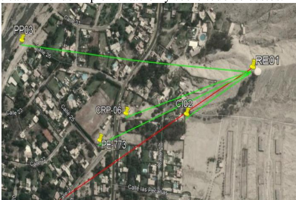
Fig. 4 Topología tipo estrella para el diseño de radioenlaces en la banda de 400MHz
