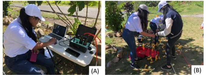
Fig. 4 (a) Dispositivos empleados para la adquisición de datos y (b) proceso de instalación de geófonos.
