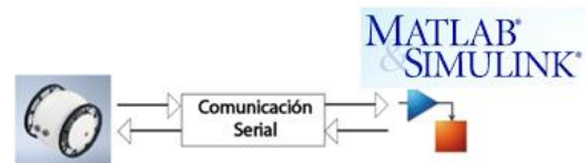
Figura 10: Comunicación serial del robot al simulink
