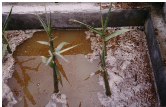
Fig. 1. Diseño y vista de humedal artificial tipo Batch.
