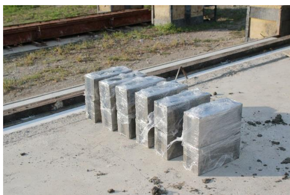
Fig. 9. Prisma hueco embalado para su curado Fuente: Propia
